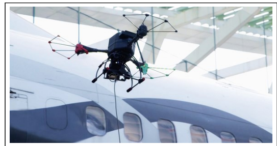
〈그림 2-10〉 드론을 이용한 동체 검사
