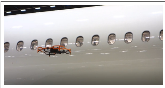
〈그림 2-11〉 드론을 이용한 동체 검사
